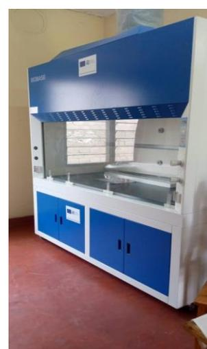
Les deux premiers matériels interviennent dans la préparation de l'échantillon, le congélateur (allant jusqu'à  $-25^{\circ}\text{C}$ ) servira à la conservation des solutions standards. L'équipement à droite est une hotte aspirante dans laquelle s'effectuera les manipulations des solvants ou réactifs qui dégagent des vapeurs nocifs à la santé humaine.
