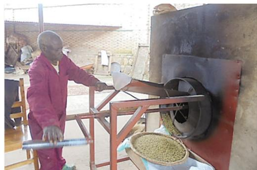
Il est composé d'un foyer incorporé, d'une tôle perforée à l'intérieur, d'un tuyau avec entonnoir pour l'alimentation de l'eau et d'un tuyau de vidange avec robinet.
