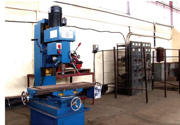
Fraiseuse des pièces métallique du service GMA au CNTA
